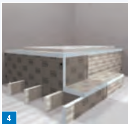
4 Cortar o lado frontal e o lado superior dos degraus do material restante. Primeiro, colar a parte frontal, depois a parte superior (≥ EL-30).
