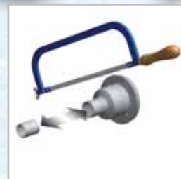
Einfaches Ablängen von DN 40 auf DN 50
