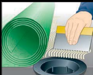
O revestimento é fixado no pavimento inferior.
