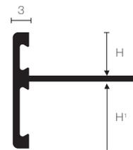
**STAIRTEC SR** è un profilo lineare utilizzabile come terminale per i bordi del gradino, gli angoli a vista e gli accostamenti tra ceramica/legno e materiali diversi, coprendo la fuga tra alzata e pedata, rifinendo ed irrobustendo lo spigolo del gradino. Il dentino verticale consente la sovrapposizione all'eventuale rivestimento o strato di intonaco verniciato, nascondendo la giunzione tra i due diversi materiali ed evitando successive fessurazioni.
