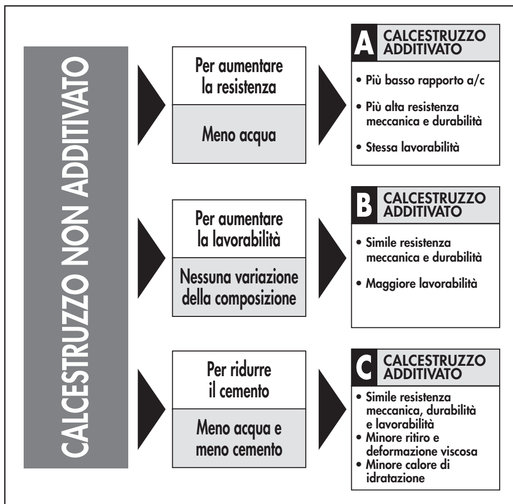
Fig. 2 - Tre diverse modalità di impiego per trarre vantaggio dall'additivo Mapefluid R104
