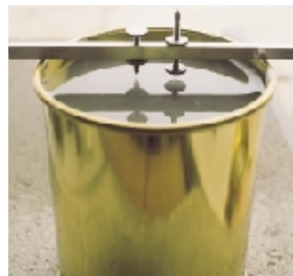
Teste de expansão livre em fase plástica segundo a norma UNI 8996/89
