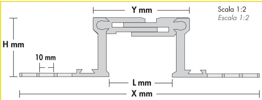
La struttura realizzata in alluminio, avente la parte di appoggio al supporto forata, permette un corretto posizionamento e fissaggio meccanico del giunto al fondo di posa. Il particolare disegno e spessore dei profili consentono un'alta resistenza ai carichi incidenti nonché la completa mobilità nelle tre direzioni. Lunghezza barre standard: ml. 4,00
