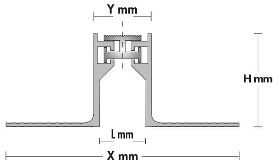
La struttura realizzata in alluminio, avente la parte di appoggio al supporto forata, permette un corretto posizionamento e fissaggio meccanico del giunto al fondo di posa. Lunghezza barre standard: ml. 4,00.
