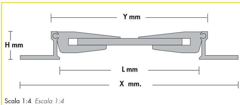
La struttura realizzata in alluminio, avente la parte di appoggio al supporto forata, permette un corretto posizionamento e fissaggio meccanico del giunto al fondo di posa. Il particolare disegno e spessore dei profili consentono un'alta resistenza ai carichi incidenti nonché la completa mobilità nelle tre direzioni. Lunghezza barre standard: ml.2,00
